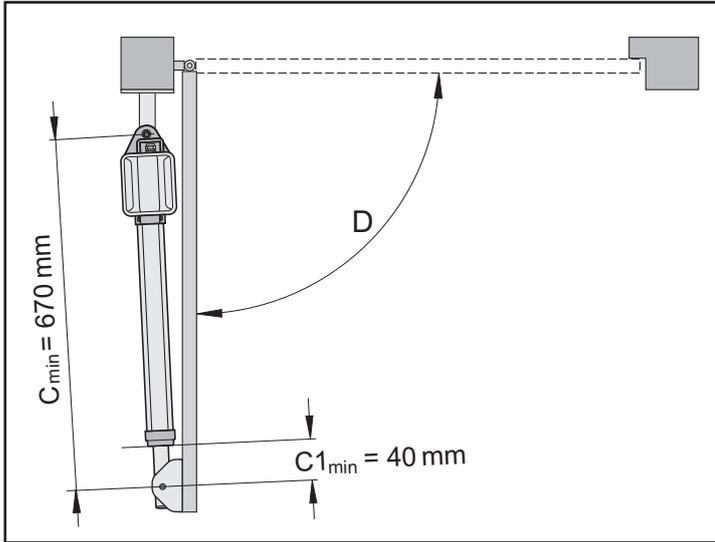
6. Tor von Hand in gewählte „Tor AUF“-Position bringen. Maximal möglichen Öffnungswinkel D aus der A-/B-Maßtablelle beachten.
