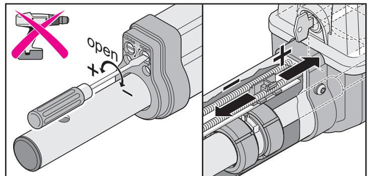
Bei Bedarf Endlage mit einem Schraubendreher nachstellen.
