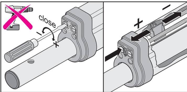
Bei Bedarf Endlage mit einem Schraubendreher nachstellen.
