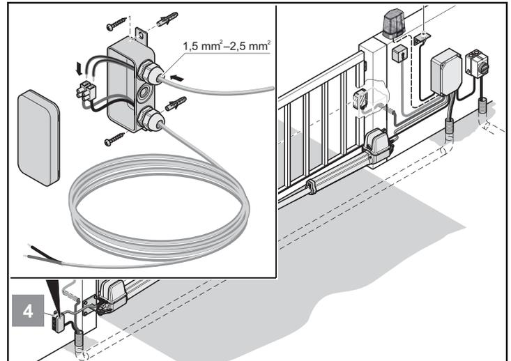
1. Abzweigdose mit Schrauben an vorgesehenen Ösen befestigen.
